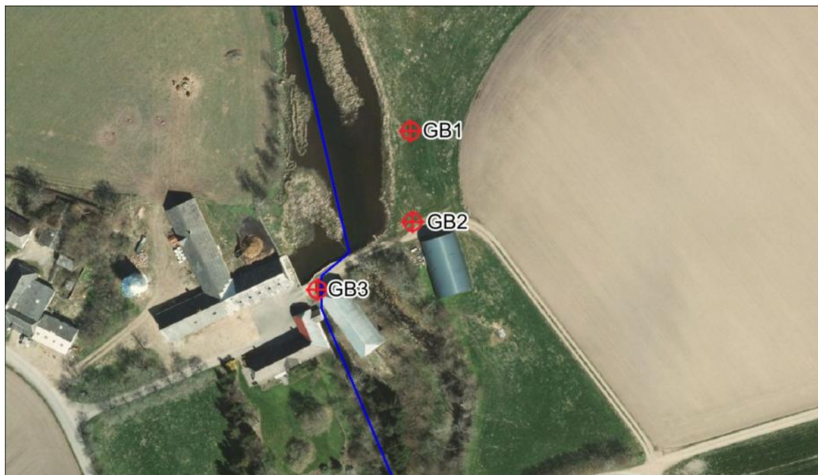
Figur 10 Placering af geotekniske borer ved Gundestrup Mølle.
